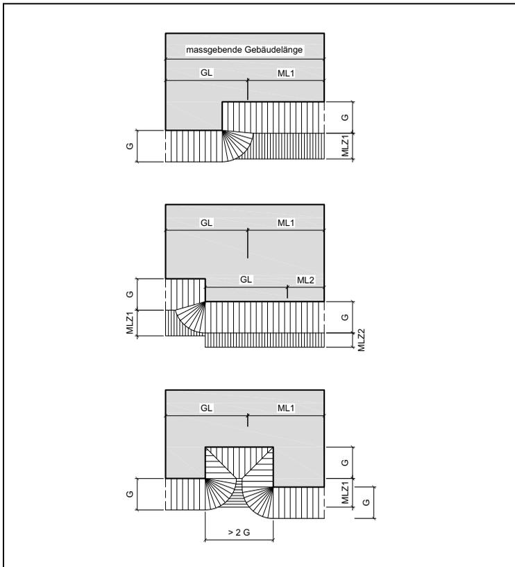
**Figur 7.7 Grenzabstand eines komplizierten Baukörpers (§§ 21–26 ABV)**
