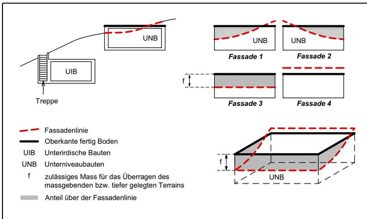
**Figur 3.1 und 3.2 Fassadenflucht und Fassadenlinie (§§ 6, 6 a ABV)**
