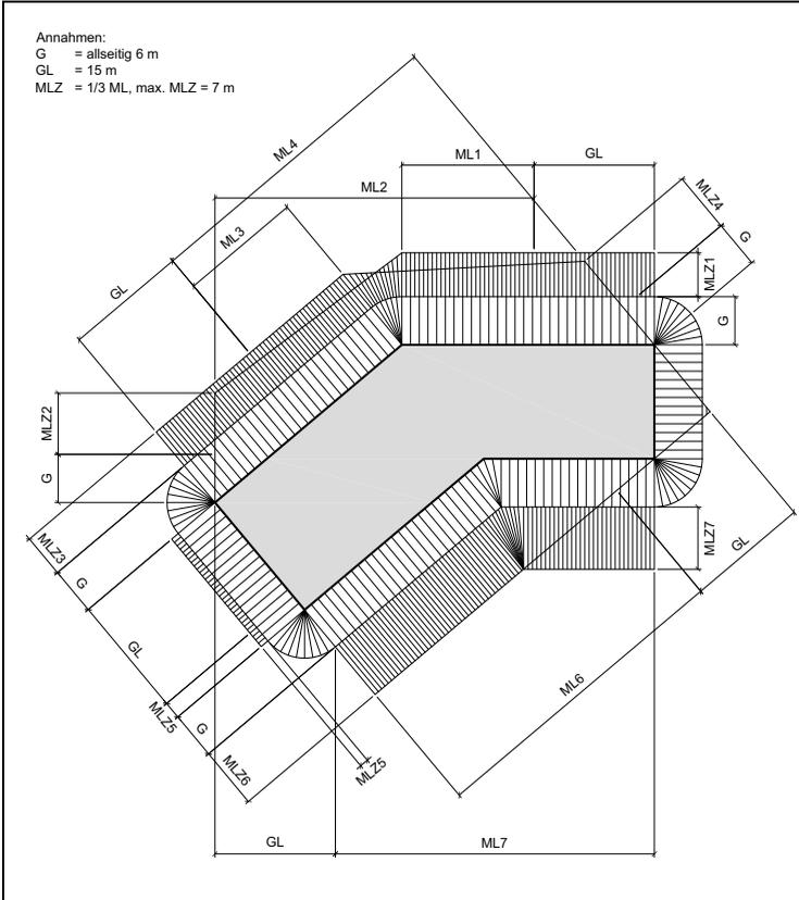
**Figur 7.8 Grenzabstand eines abgerundeten Baukörpers (§§ 21–26 ABV)**
