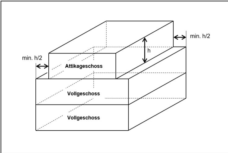
**Figur 7.1 Bebaubarer Bereich und Baubereich (§ 7 ABV)**
