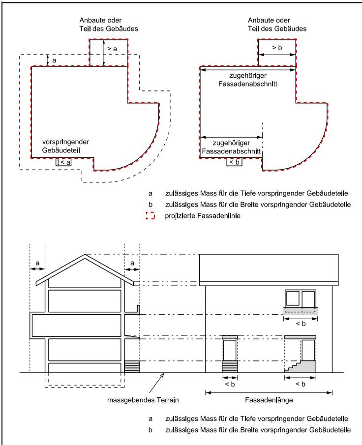
**Figur 3.5 Rückspringende und unbedeutend rückspringende Gebäudeteile (§ 6 d ABV)**
