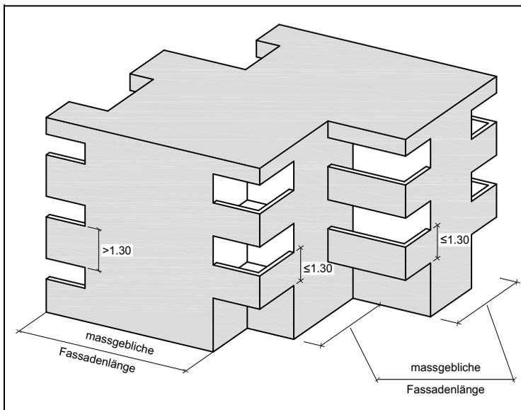
**Figur 7.13 Fassadenhöhe mit Einfluss von Grenz- und Baulinien-
