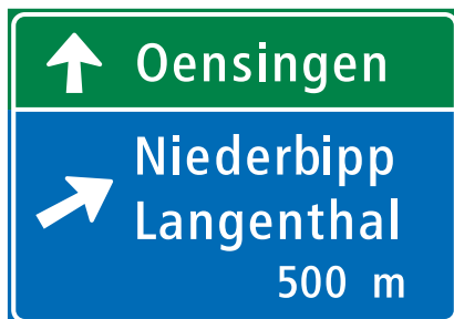
4.61 Vorwegweiser bei Anschlüssen (Art. 86)
