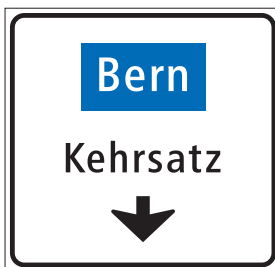
4.42 Einspurtafel über Fahrstreifen auf Nebenstrassen (Art. 53)
