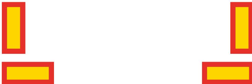
**10 Heckmarkierungstafel für Fahrzeuge mit einer Höchstgeschwindigkeit bis 45 km/h**
