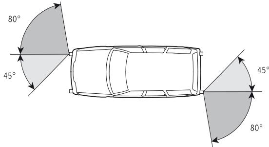
Bei Fahrzeugen der Klassen  $M_1$  und  $N_1$  können die horizontalen Sichtwinkel nach aussen auf  $45^\circ$  reduziert werden, wenn vorne bzw. hinten ergänzende seitliche Markierlichter mit einer Leuchtfläche von mindestens je  $12,5 \text{ cm}^2$  angebracht sind.
